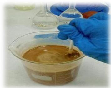
**Figure 17:** Photo représenté lavage de la boue (AQS,2023)
